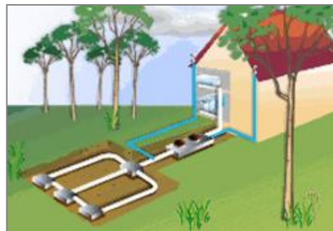
Figure 3. Schéma d'une installation individuelle. Source : MEEDM
